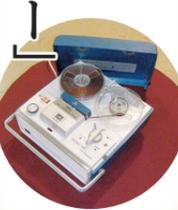
「おはよう、フェルプス君」と、小型のオープンリールのテープレコーダーから難解な指令が再生され、白い煙とともにテープが消滅する。これは、1960年代後半に世界中で大ヒットしたテレビドラマ「スパイ大作戦」のお決まりの場面です。1950年に、日本で初めてテープレコーダーが発売されました。テープの表面には磁石の働きをする粉が塗ってあり、録音するときには音を電気信号に変え、さらにNとSの磁石信号に変えてテープに記録します。再生するときは、テープの磁石信号を読み取って電気信号に変え、スピーカーを通して元の音に戻るとい仕組みです。
