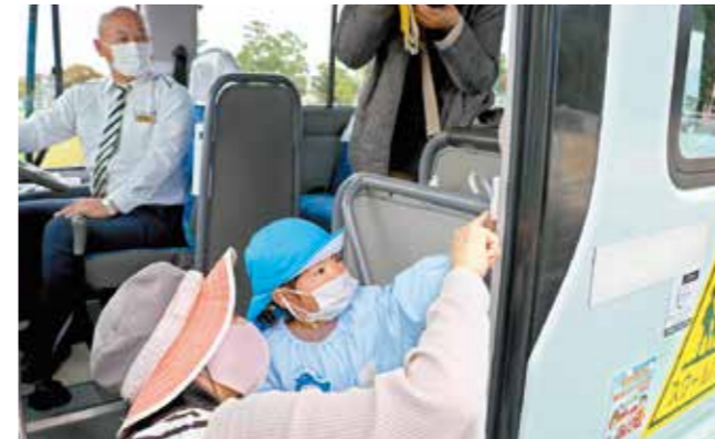
運行会社の車庫に戻ったバスに取り残された場合、ボタンを押すとバス会社の事務所にブザー音とフラッシュの光で異常を知らせます。
