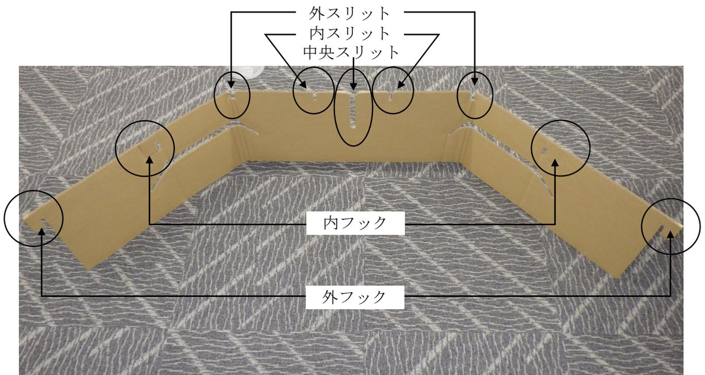
1 ベースを折曲線(黒点線)に沿って折り曲げ、外フックを内スリットに差し込む
